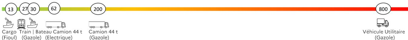
Figure 9 - Emissions de CO2 par tonne-kilomètre par mode de transport de marchandises<sup>67</sup>
